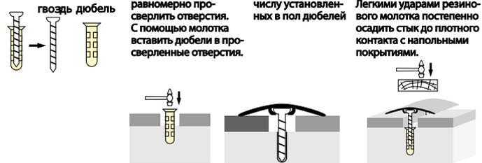
**Схема крепления углов со скрытым креплением**
